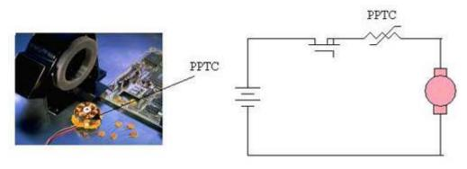
在这些应用中,当这些系统由于过电流或过热状态而导致外部故障时,PPTC器件能够允许电机驱动和控制器系统继续运行。其优点在于提供了一种功能强大和可靠的产品,在其它部件出现故障时可以保护系统。
