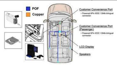
这套视频-音频网络包括一个用户便利端口(CCP),可供乘客将自己的 CD 机、游戏机和其它应用 1394 总线的设备和外设连接到网络中,所配电缆通用于家中和车上。
